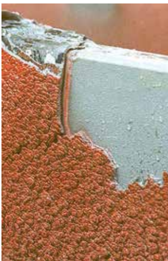
4000 tr/min (vitesse maxi) pour décapage de revêtement
